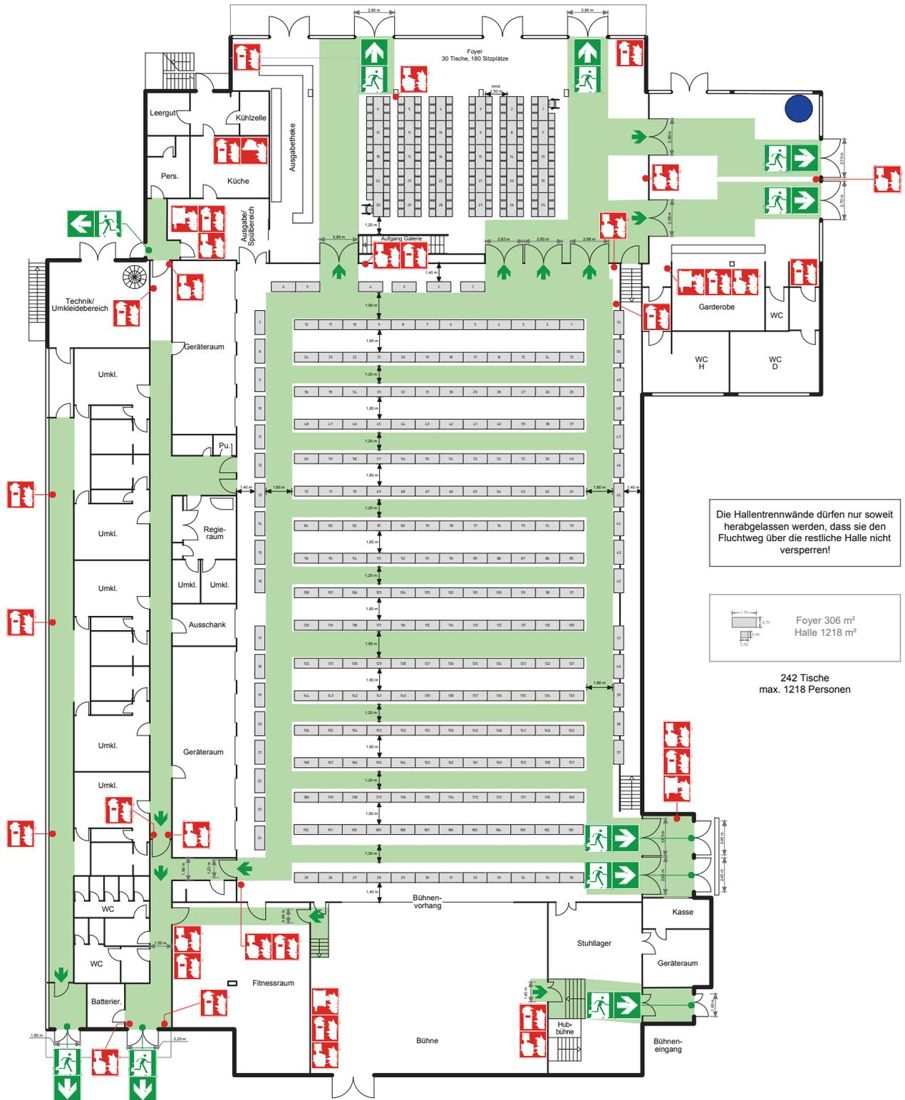
Die Hallentrennwände dürfen nur soweit herabgelassen werden, dass sie den Fluchtweg über die restliche Halle nicht versperren!
